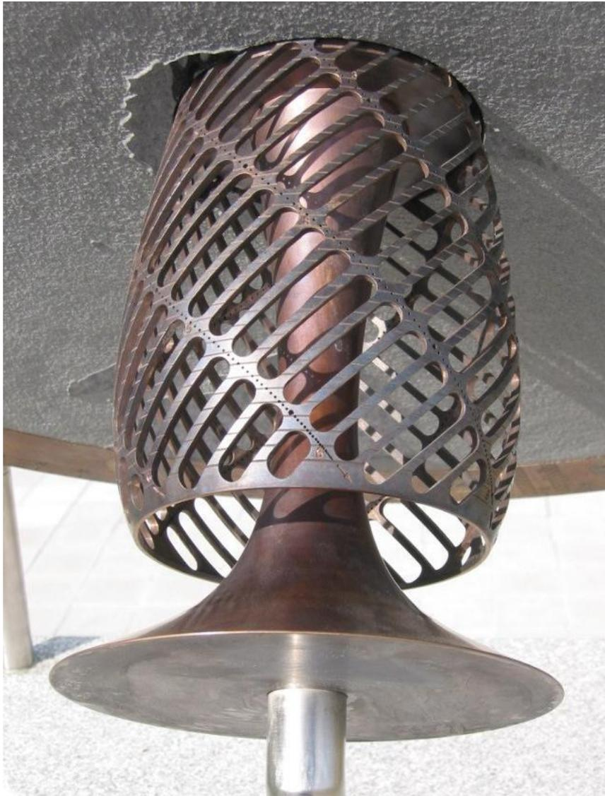
Für die Datumskala wurden waagrechte (äquatoriale) Linien an den Zeigern angebracht. Man sucht zuerst jene Linie welche den Schattenrand berührt. Dann folgt man dieser Linie nach links oder rechts bis zur Diagonalen.
